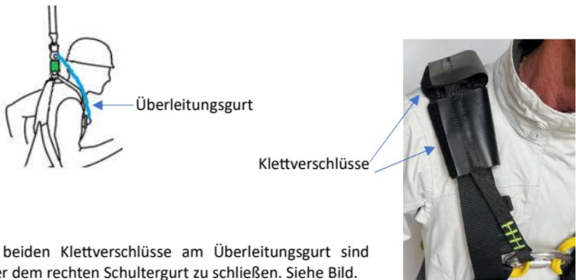
Es ist darauf zu achten, dass der Fallämpfer beim Anlegen des Sicherungsgurtes NICHT irrtümlich unter dem Überleitungsgurt durchgeführt werden darf, wodurch die Funktion des AKM beeinträchtigt werden könnte.
